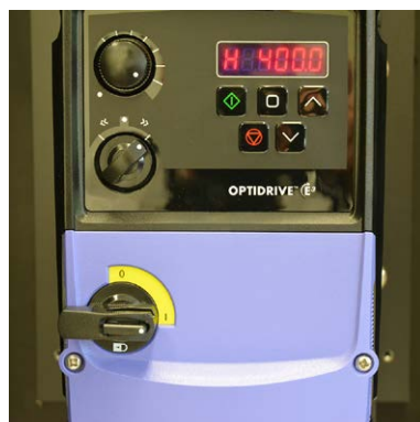
Fig. 8e Switch 3 set to the max 400 Hz
